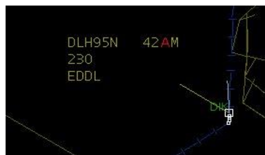
Abb. 7: Radar Label mit UAC "Time to Lose" >360 Sekunden
