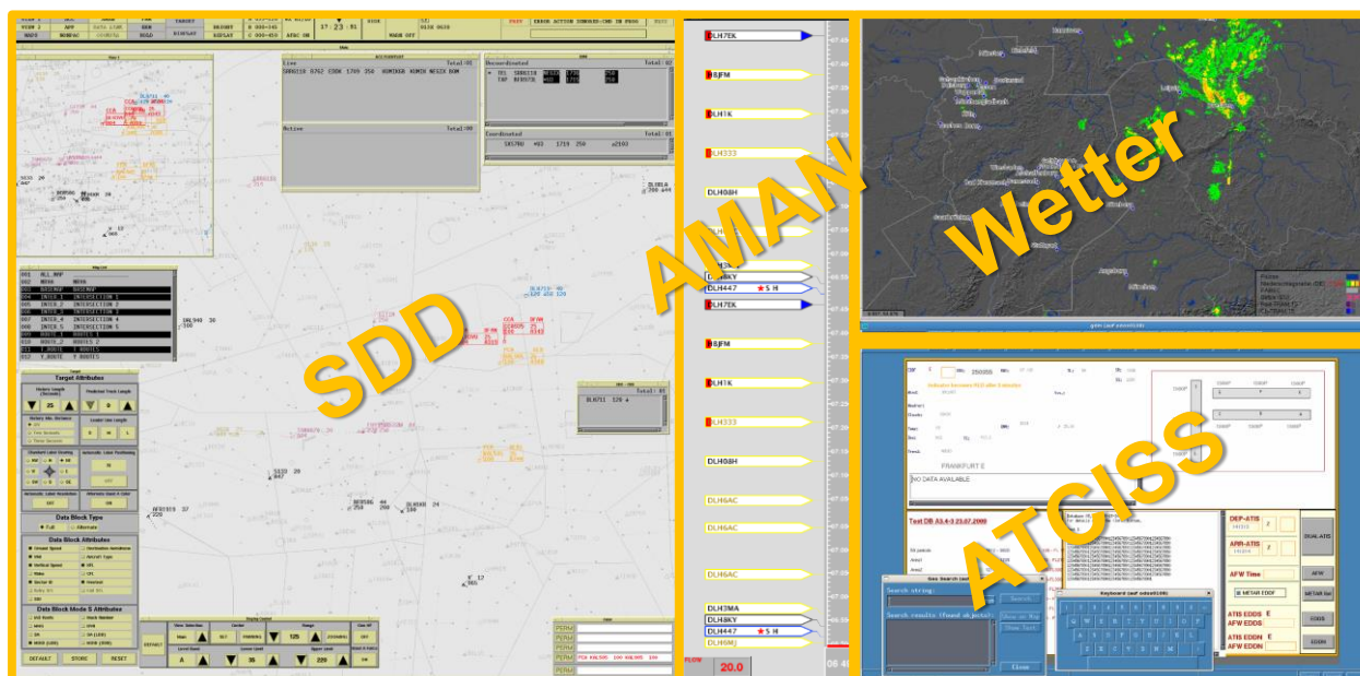
Abb. 8: Testbild auf einem Breitbild-Monitor als Variante zur Nutzung der freien Displayfläche neben der Luftlagedarstellung
