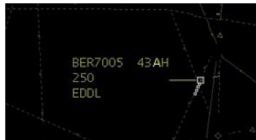
Abb. 6: Radar Label mit UAC "Time to Lose" zwischen 180 und 360 Sekunden
