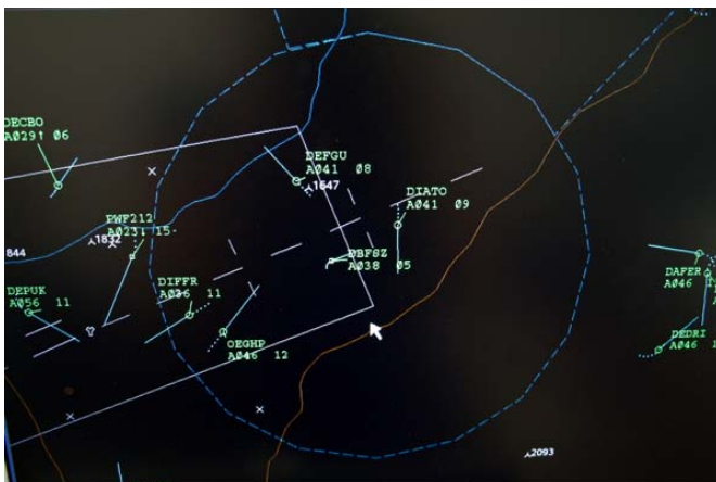
Abb. 1: Luftlagedarstellung auf dem Phönix System der DFS (LUNA Callsign: DBFSZ)
