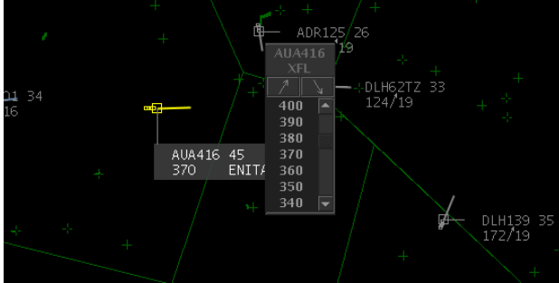
Abb. 8: streifenloses System: Interaktion zur Koordination eines Exit Flight Level (Sysco) via ASW
