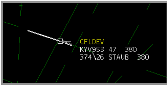
Abb. 8: Beispiel für MONA-Anzeige beim Abweichen von freigegebener Höhe
