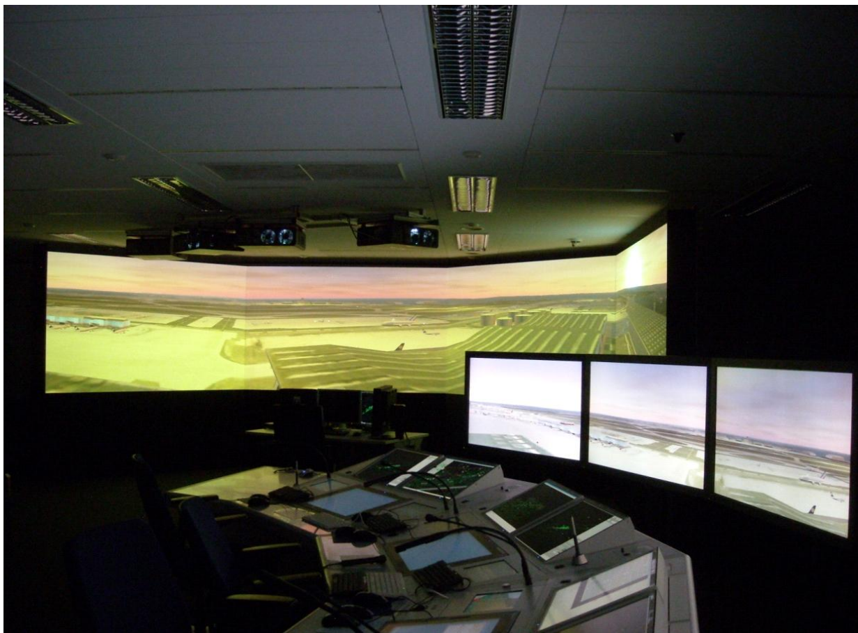
Abb. 1: Das iPort-Testsystem integriert im TOSIM 3D-2; hinten: vierkanaliges Projektionssystem für PL-P (Platzlotse Parallelbahnsystem), vorne: restliche Arbeitspositionen (PG-T, PL-W, PG-D, PL-N)
