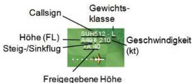
Abb. 7: Label des Luftfahrzeugs mit den für den Lotsen relevanten Informationen
