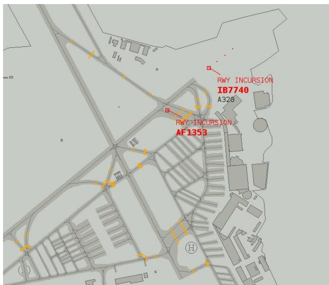
Abb. 3: Darstellung eines Safety Net Alarms auf der Bodenlagedarstellung (Ausschnitt)
