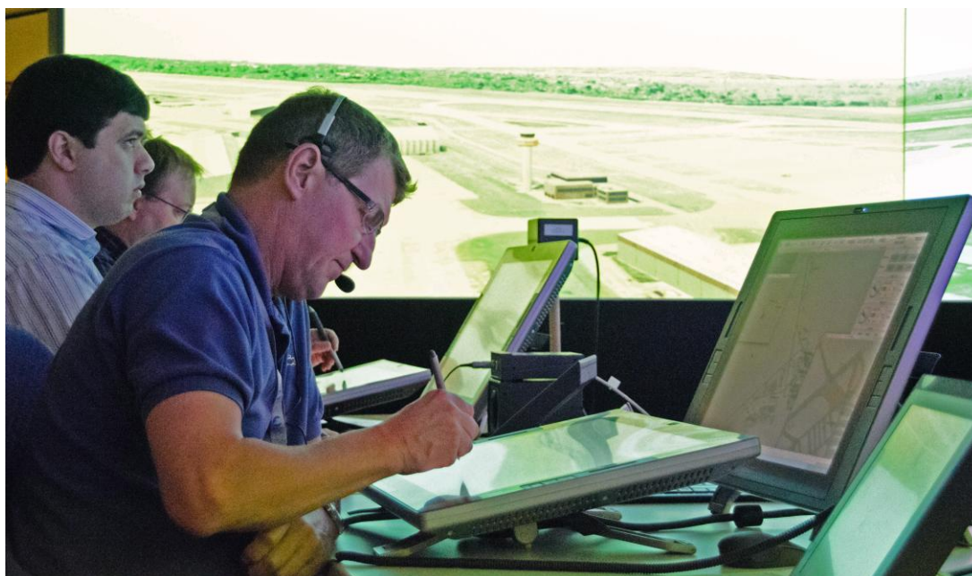
Abb. 2: Die iCWP: integrierte Nutzung von Flugstreifenanwendung (unten, liegend) und kombinierter Luft- und Bodenlage (dahinter, stehend)
