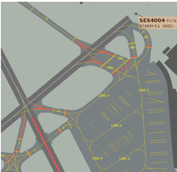
Abb. 11: Aktivierte RWSL-Segmente (rote Linien) zum Schutz eines landenden Flugzeugs
