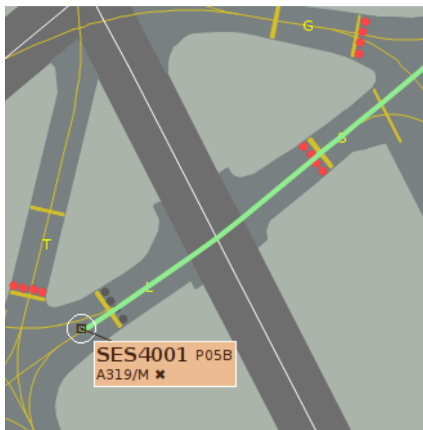
Abb. 9: Vor dem mit einer „Cross Runway“-Freigabe ausgestatteten Flugzeug wird der Haltebalken automatisch ausgeschaltet (graue Kreise); später wird er automatisch wieder aktiviert, sobald das Flugzeug ihn passiert hat
