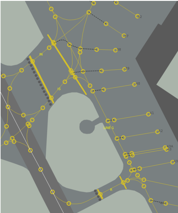
Abb. 1: Ein Routenplanungsnetzwerk (ASRN); Knoten dargestellt als gelbe Kreise, Kanten als gelbe, weiße und schwarze Linien (gelb und weiß: Verbindungen entlang realer Bodenmarkierungen; schwarz: zusätzliche Verbindungen ohne zugrundeliegende Bodenmarkierung)
