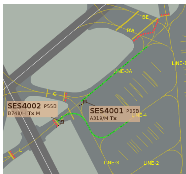
Abb. 10: Rollführung zweier Flugzeuge durch vor ihnen aktivierte Segmente der Mittellinienbefeuerung (grüne Lampen)
