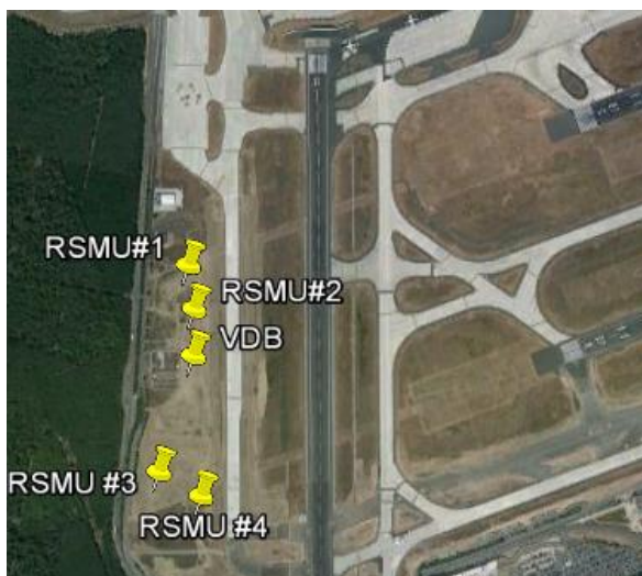
Abb. 6: Finaler Standort der GBAS-Antennen in Frankfurt
