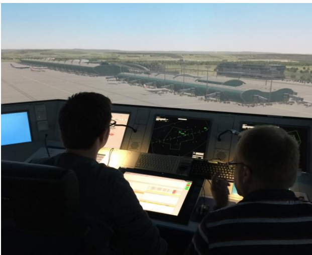
Abb. 2 Testbetrieb der bilingualen Spracherkennung an der Clearance Delivery Position im Towersimulator
