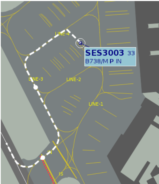
Abb. 3: Eine geplante Rollroute in der Bodenlagedarstellung des PHOENIX-Prototypen
