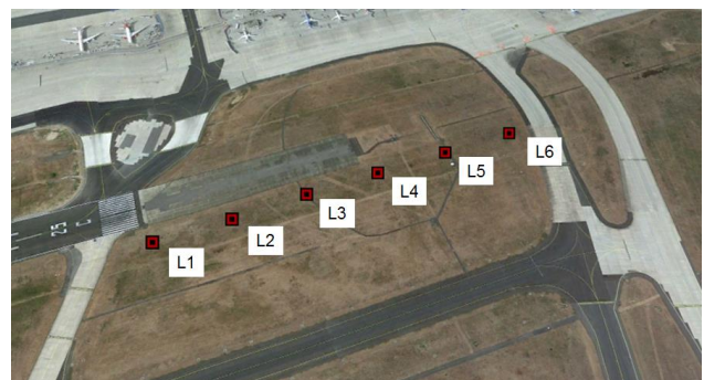
Abbildung 6: Positionierung und Ausrichtung der AALS Befeuerungselemente
