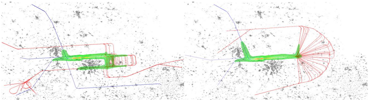
Abbildung 8: Beispiele für eine Lärmrechnung auf Basis von Schnellzeitsimulationen (Transitions BR26 links, Point Merge BR26 rechts)
