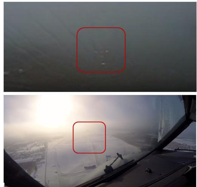
Abbildung 3: Visuelle Merkmale bei Erreichen der CAT I Entscheidungshöhe [eigene Abbildung]
