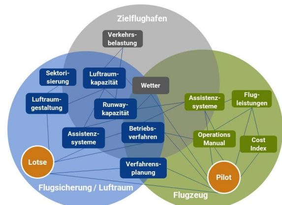
Abbildung 4: Abhängigkeitsdiagramm der verschiedenen Einflussfaktoren auf die Möglichkeiten einer optimierten vertikalen Flugführung (Ist-Situation).
